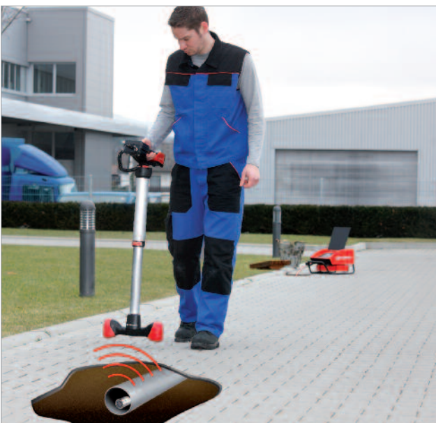
Lokalisatie van de camerakop met module ROLOC PLUS
